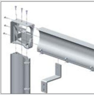
**IT.** cornice outdoor invisibile per stampe digitali di grande formato. gli angoli vengono avvitati direttamente sui profili del supporto. un sistema sicuro, che esclude il bisogno di tagliare i profili a 45°. dadi e clip per banner possono essere inseriti nel profilo anche dopo aver effettuato il montaggio. il bordo del banner viene agganciato alla parte posteriore del profilo: il fissaggio posteriore permette di nascondere facilmente eventuali irregolarità della stampa.
