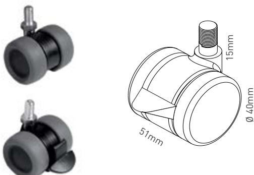
**IT.** ruota doppia ricoperta in TPU Ø40mm, 2 con e 2 senza freno, montaggio con base piede.
