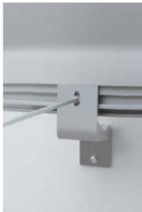
**IT.** montare il gancio a parete, fissare i dadi nel profilo - siccome non vengono inseriti nella cava, è possibile aggiungerne anche dopo aver terminato il montaggio della struttura. fissare il profilo al gancio. distanza dalla parete del banner: 130mm.
